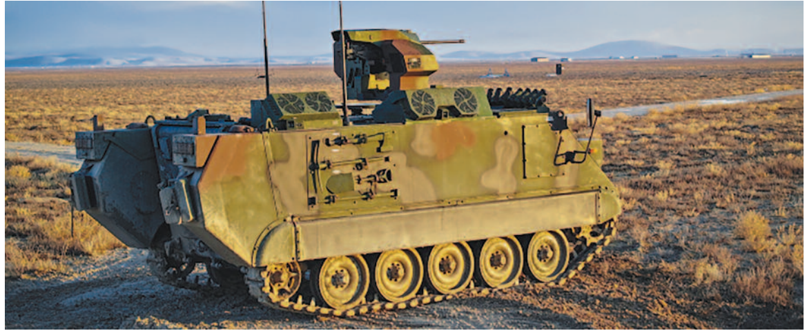
MKE tarafından M113 serisi zırhlı personel taşıyıcının modernize edilmesi ile üretilen E-ZPT, Mehmetçiğin sahadaki beklentilerini karşılamak üzere en son teknoloji ürünler ile donatılarak adeta baştan yapıldı.
